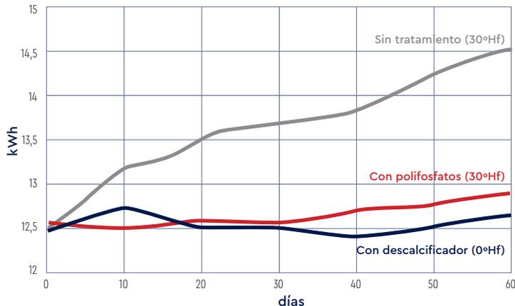
Condiciones test: caldera condensación, funcionamiento 3h/día durante 60 días, T: 30°C, caudal 6 l/min
