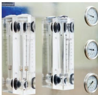
**A la salida de la membrana de ósmosis se obtienen dos flujos de agua: el caudal de permeado y el de rechazo.**
