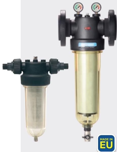
» Sistema de prefiltración ciclónica gracias a la hélice interior que crea una acción centrífuga al paso del agua, mejorando la separación de los sólidos más gruesos y obteniendo una eficacia de filtración mayor.
